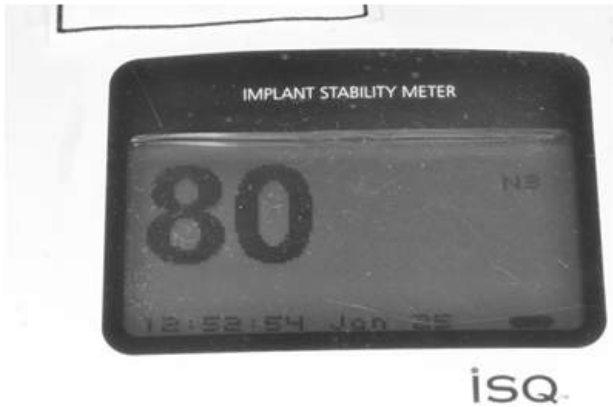
그림 16e. 임플란트식립 직후Osstell(Nobel Biocare, Sweden)을 이용하여 RFA(resonance frequency analysis) 값을 측정하여 80 정도의ISQ값을 얻었고, 초기 고정은 50Ncm 이상의 양호한 결과를 보였다.
