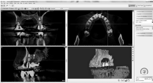
그림 21a. CT 자료를 바탕으로 심플란트 프로그램상에서 모의수술을 진행하고, 임플란트의 식립 위치, 방향과 깊이 등을 결정하고 계측값을 구한다. 또한 임플란트 식립 부위 각각의 골질에 맞는 드릴링 과정도 대략적으로 결정해둘 수 있다.
