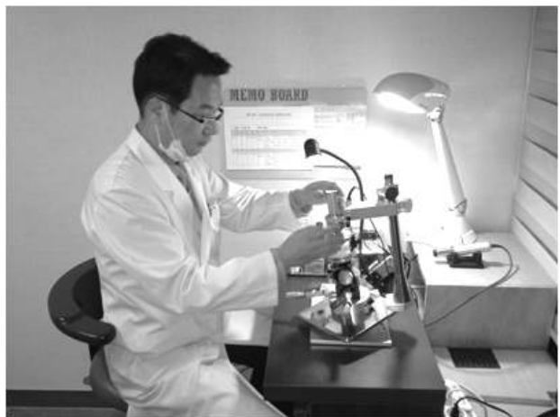
그림 6a. 심플란트 프로그램에서 계산한 각 임플란트의 위치와 식립 각도 및 식립 깊이의 계측값을 바탕으로 IPS 3축 장비인 IMPLA 3D를 이용하여 엑스레이용 스텐트를 수술용 가이드로 변환시키는 작업을 하고 있는 모습.
